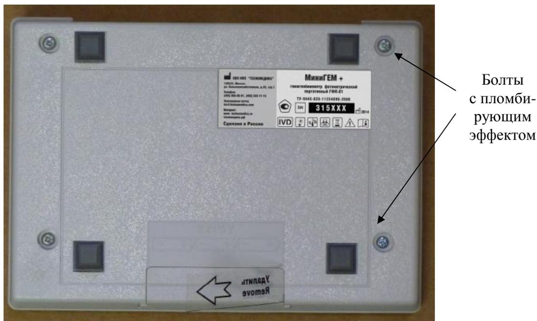
Рисунок 2 - Схема маркировки и пломбировки
