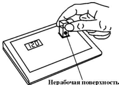
Рис. 4. Установка оптической кюветы
