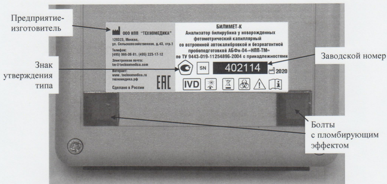
Рисунок 2 – Схема маркировки и пломбировки
