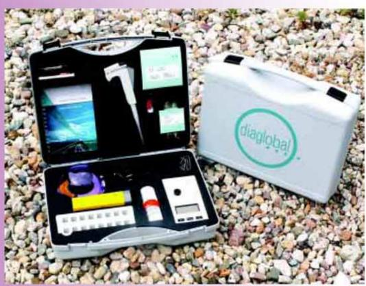
Рис. 1. Мобильная фотометрическая лаборатория фирмы «Diaglobal GmbH», Германия
