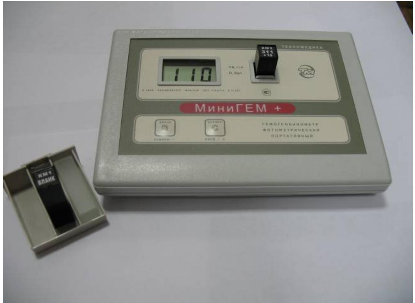
Нажми на кнопку **C**, сравни числа на дисплее и на шильдике меры КМ2. Если числа в допуске, проведи калибровку анализатора
