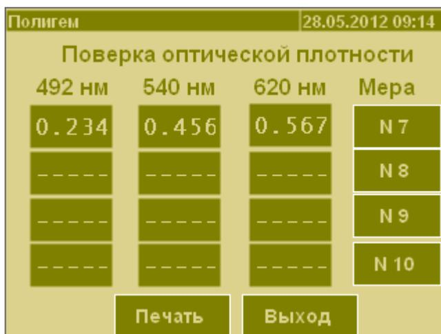
Рисунок 15. Экран для выполнения поверки оптической плотности
