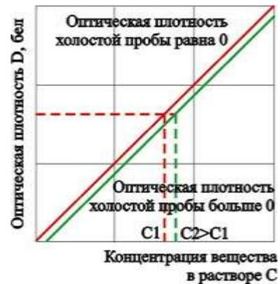
Рис. 6. Влияние спектральной полосы пропускания светофильтра на измерение оптической плотности. Рис. 7. Влияние холостой пробы на результат измерения.
