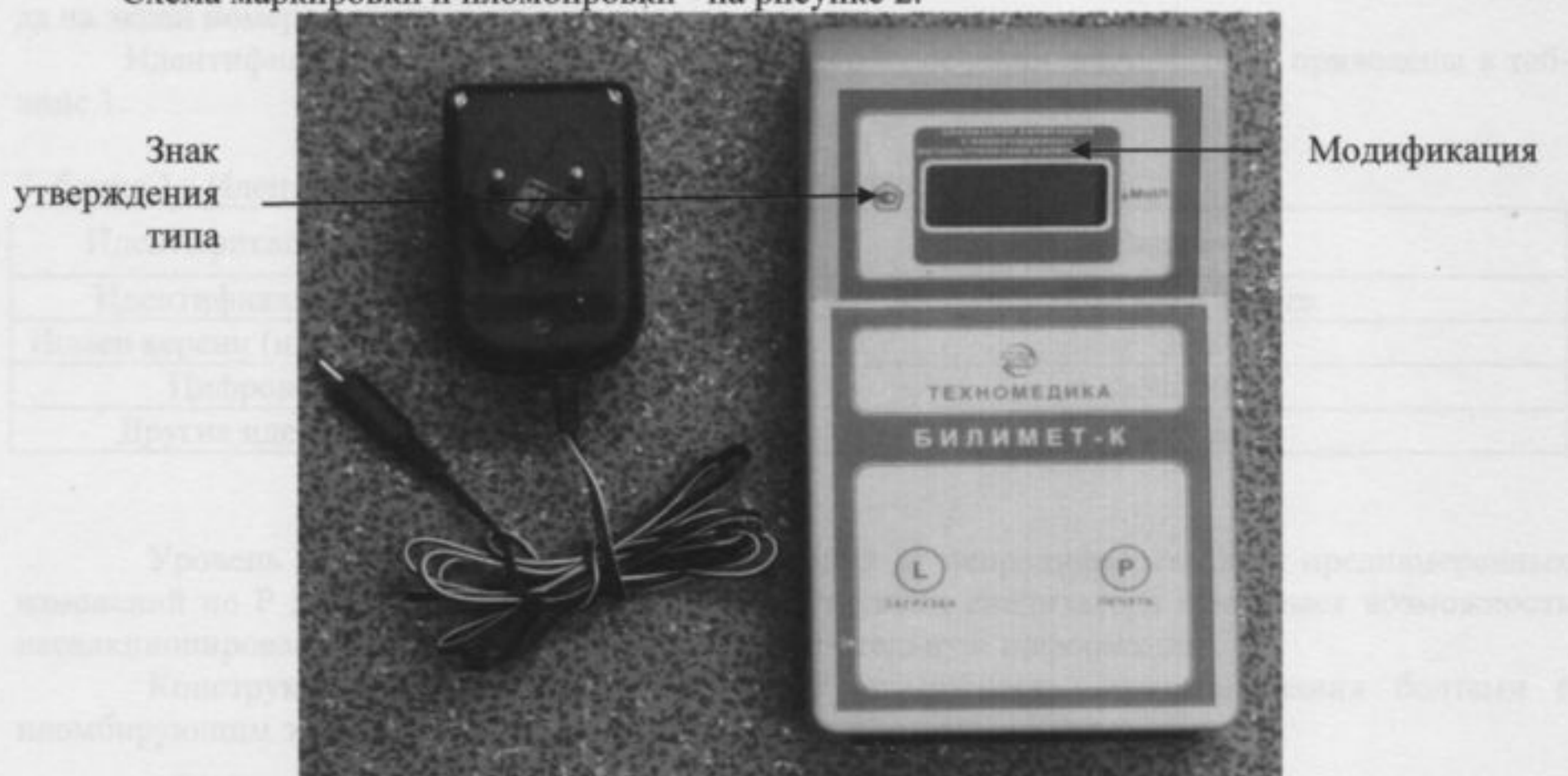
Рисунок 1 – Общий вид анализатора билирубина у новорожденных фотометрического капиллярного со встроенной автокалибровкой и безреагентной пробоподготовкой АБФн-04-«НПП-ТМ»
