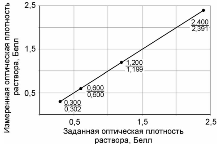
Рисунок 2. Контроль линейности фотометра в спектральном диапазоне 340 нм. Измерялась оптическая плотность 4 последовательных разведений раствора бихромата калия из набора REDI CHECK фирмы Awareness Technology, США.
