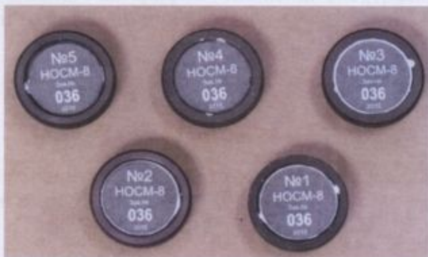
Рисунок 1 - Общий внешний вид наборов стеклянных мер НОСМ-8
