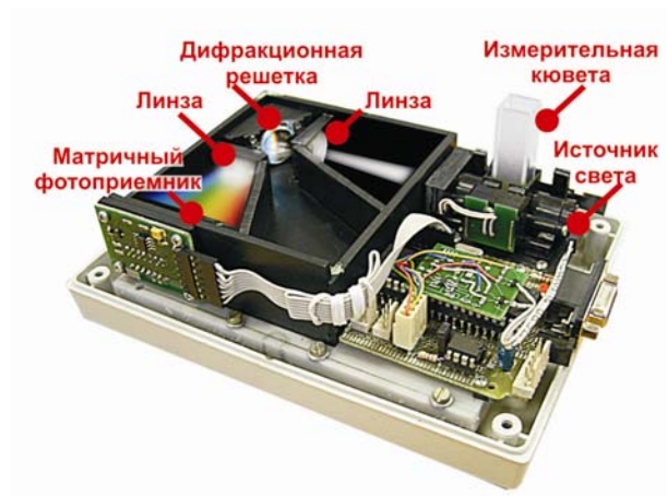
Рис.1. Конструкция спектрофотометра.
