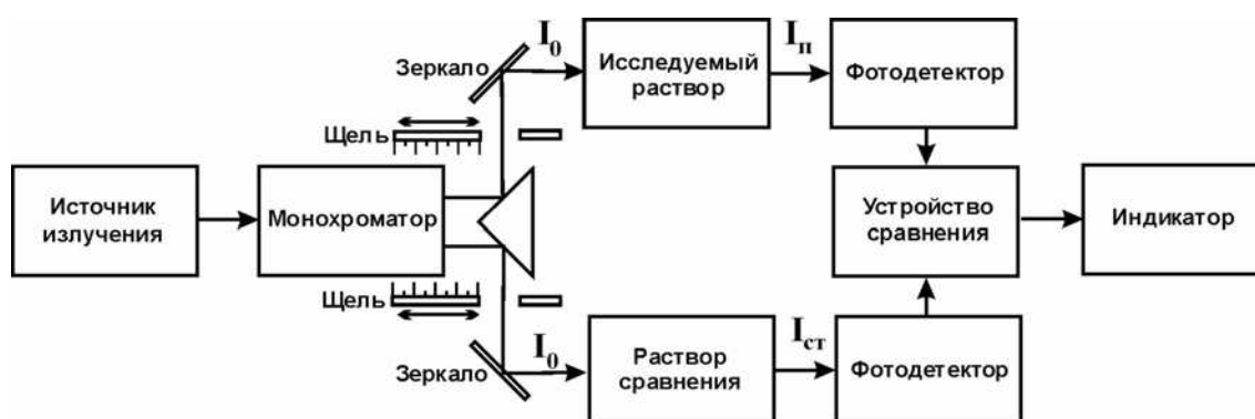
Рис. 78. Схема двухлучевого фотометрирования с одним монохроматором, с двумя фотоприемниками и устройством сравнения.
