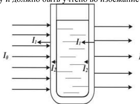
Рис. 9. Отражение света от стенок кюветы с неокрашенной прозрачной жидкостью. I_0 – падающий свет; I_1 – свет, отраженный от границы раздела воздух-стекло; I_2 – свет, отраженный от границы раздела жидкость-стекло; I – прошедший свет.
