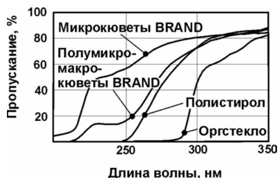
Рисунок 105. Спектры пропускания пластиковых кювет
