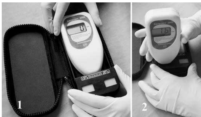
Рис. 132. 1 - Внешний вид анализатора Билитест 2000, 2 - проверка анализатора с помощью имитаторов кожи.
