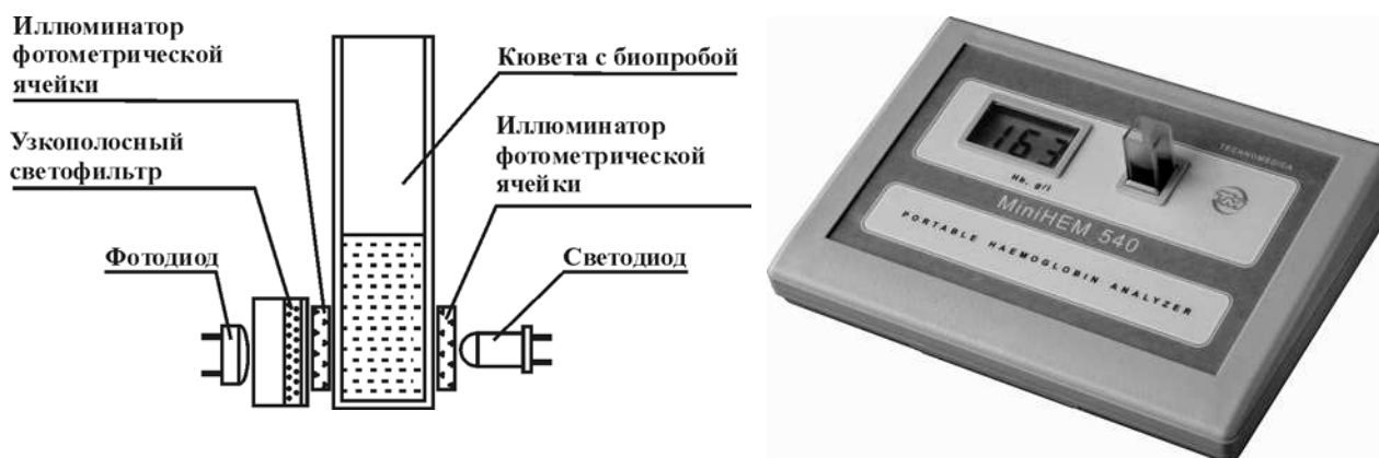
Рис. 122. Гемоглобинометр МиниГЕМ - оптическая схема и внешний вид.
