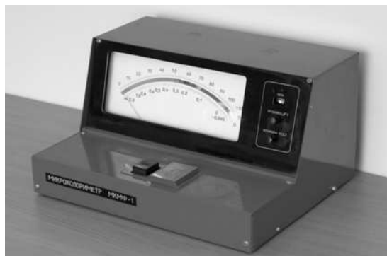
Рис.116. Микроколориметр МКМФ-1: оптическая схема и внешний вид.
